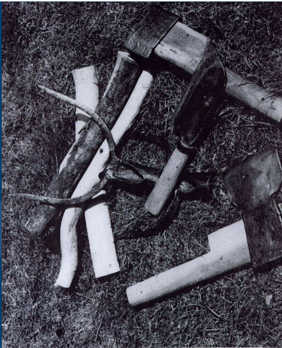
Het gereedschap van een eekschiller. Klopsteen, Schilhamer, Bijlen, Zaag en Hiep.
