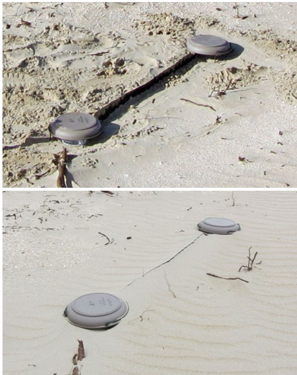
Afb. 19: Bodemval na plaatsing op een stuivend deel van het terrein, begin maart, en dezelfde val 10 dagen later. (foto: J. de Rond)
