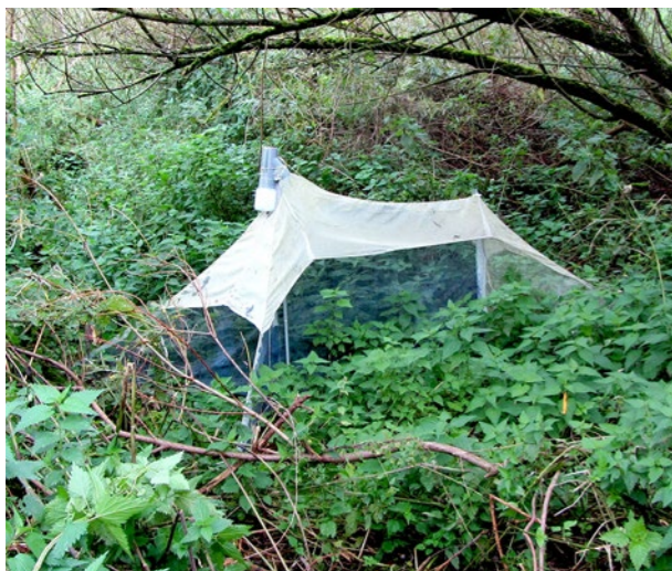
Afb. 15: Trapeziumvormig model malaiseval. Vliegende insecten stuiten op het donkere gaas en kruipen omhoog naar de nok. (foto: J. de Rond)
